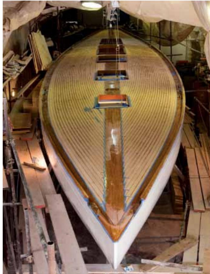
Une restauration extrêmement soignée avec des bordés d'acajou rivetés et calfatés, une quille en chêne et iroko, un pont en lattes de pin de Douglas et une coque enduite.
